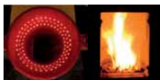
Καυστήρας με τυρβώδη ροή καυσαερίων
