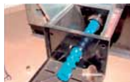
Χυτοσίδηρος κοχλίας με θερμική επεξεργασία σκλήρυνσης
